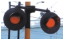
信号機・踏切警報機の電球をLED(発光ダイオード)に取替
