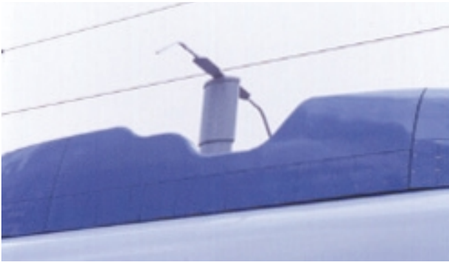
500系車両の翼型パンタグラフとパンタグラフカバー
